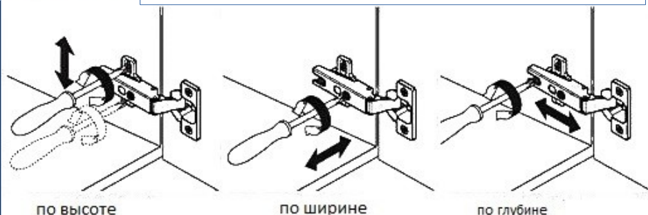
регулировка петель
