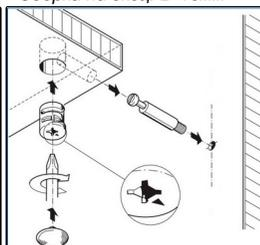
Сборка на эксц. D-20мм
