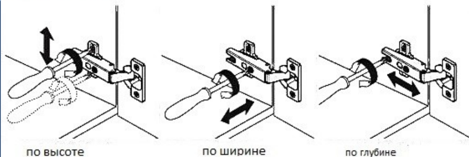
регулировка петель
