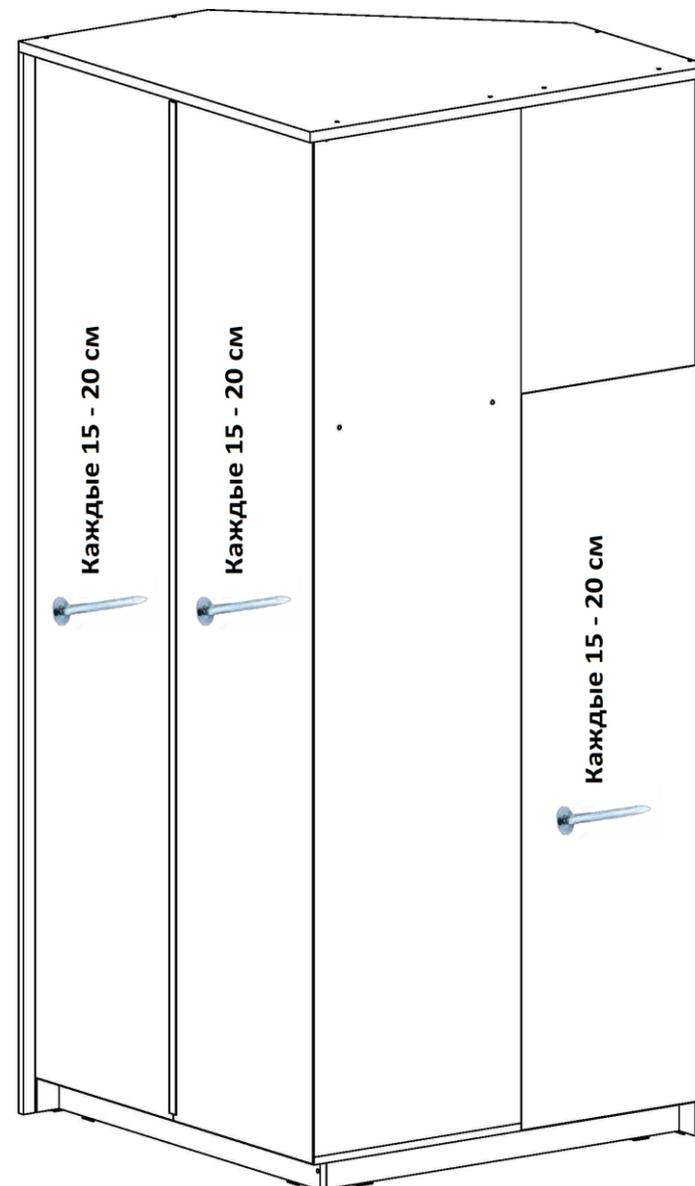
Установите перегородку между горизонтами на VB-35. В перегородку вставьте полкодержатели. Прикрутите царгу под крышкой на саморезы. Положите полки на полкодержатели.
